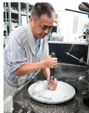
Das Herzstück der Objektivherstellung sind meisterhafte Handwerker. Hier beginnt Toshi Saito mit der Herstellung der ursprünglichen Linse, die anschließend von automatisierten Maschinen weiterverarbeitet wird. *Aufgenommen mit einer Canon EOS 5D Mark IV mit einem Canon EF 24-105mm F4 L IS II USM Objektiv. © Nigel Atherton*
