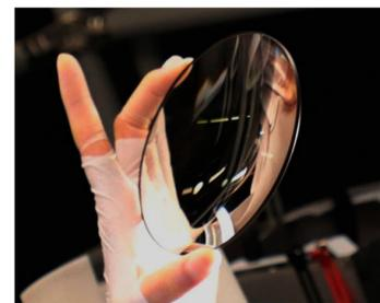
In der Objektivfabrik von Canon in Utsunomiya durchläuft das vordere Element eines Canon EF 600mm F4 L IS II USM Objektivs [mittlerweile ersetzt durch das Canon EF 600mm F4 L IS III USM] die Endphase der Prüfung, bevor es eingesetzt wird. *Aufgenommen mit einer Canon EOS 5D Mark IV mit einem Canon EF 24-105mm F4 L IS II USM Objektiv. © Nigel Atherton*
